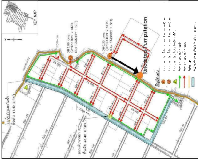
รูปที่ 6.1-2: รูปแบบการปรับปรุงและออกแบบระบบระบายน้ำสำหรับนิคมฯ บางปูพื้นที่ประกอบการเสริม
